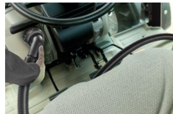
Si può richiedere un tubo di aspirazione fino a 15 metri di lunghezza, per pulire zone lontane dall'aspiratore, come le camere bianche, dove l'aspiratore può essere lasciato all'esterno, o nel settore agricolo, per aspirare l'interno dei veicoli lasciando l'aspiratore a terra
